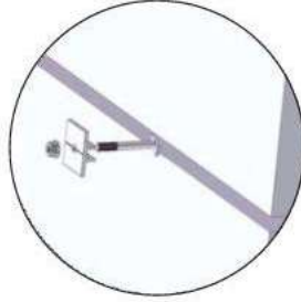
Fixação Intermediária - Peça "T" FVSol com Parafuso C.M. M8X... com Porca Anilha M8
